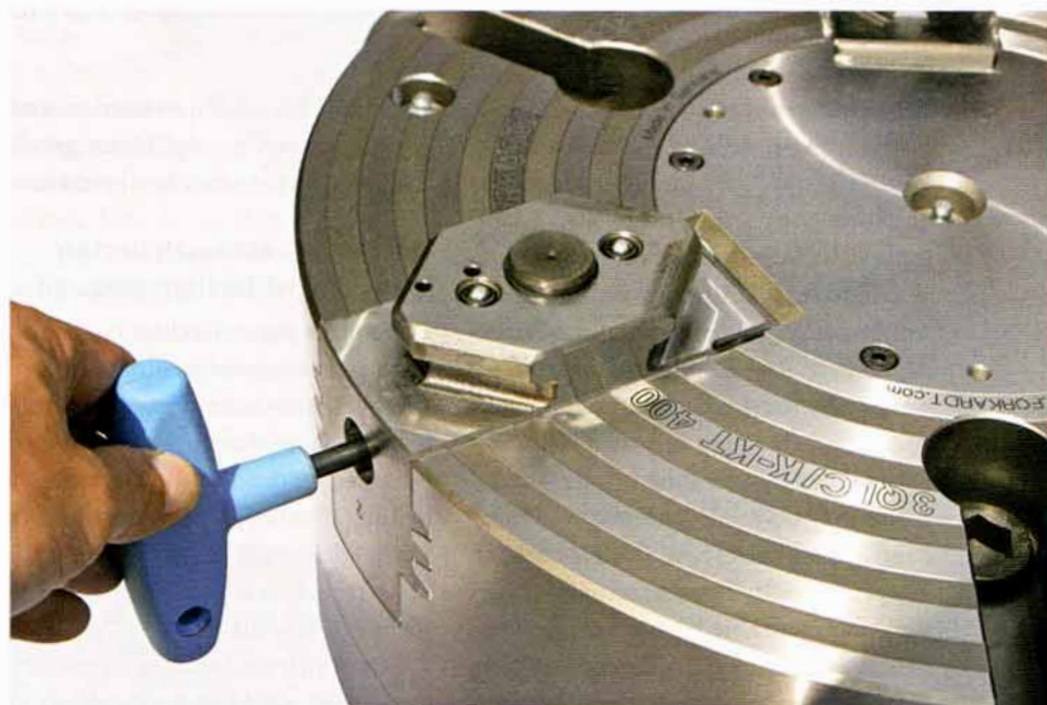
1 Ein doppelseitiges V-Profil in der Grundbacke ermöglicht das alternative Außen- oder Innenspannen von Werkstücken
