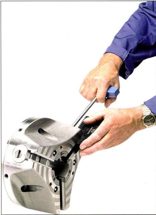
Bild 3: Über das patentierte Verriegelungssystem lässt sich das Spannfutter schnell auf verschiedene Spanndurchmesser einstellen (Werkbilder: Forkardt Deutschland GmbH, Erkrath)
