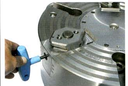
Zum Versetzen der Backen auf einen anderen Durchmesser oder Umdrehung von Innen- auf Außenspannung werden die Backen einzeln durch einen gesicherten Schlüssel entriegelt.
