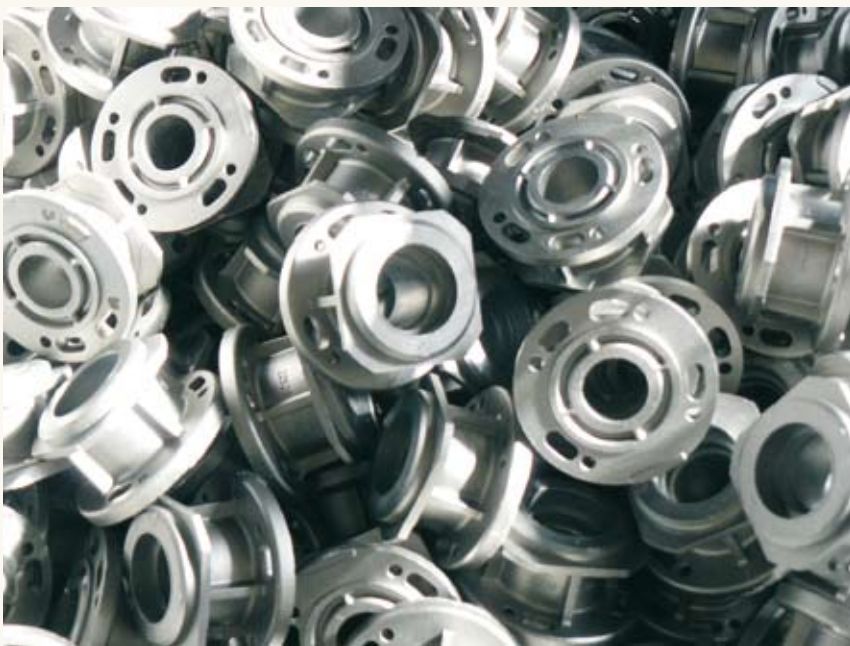
Bild 1: Es ist nicht nur die hohe Präzision bei der Bearbeitung der Lagerdeckel zu berücksichtigen sondern auch die Verformungsempfindlichkeit des Aluminium-Druckguss
