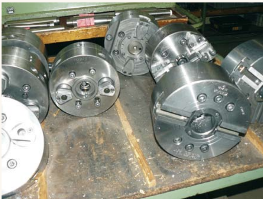
Bild 4: Mit einer Wiederholgenauigkeit von 0,02 mm überzeugen die Spannfüter selbst nach acht Jahren und werden auch bei Investitionen in neue Drehautomaten nicht ausgetauscht
