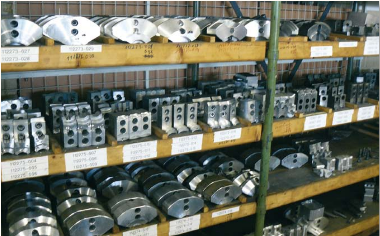
Bild 5: Insgesamt sind bei Groschopp drei Typen von Forkardt- Schnellwechselfuttern im Einsatz. Entsprechend groß ist das Lager an Spannbacken (Werkbilder: Forkardt Deutschland GmbH, Erkrath)
