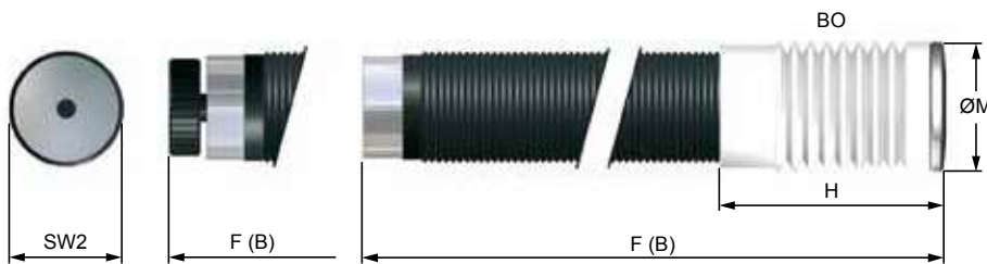
Material: PTFE / Anschlagkappe: rostfreier Stahl Bestellinformation: WS-M 1,0 - 1B0
